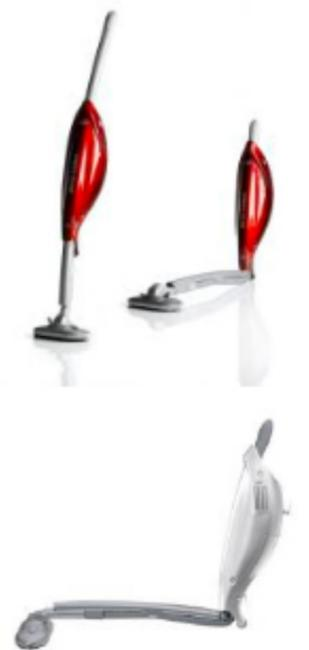
La scopa elettrica Flexica, disegnata per Imetec nel 2005. Il giunto che collega corpo motore/sacchetto e tubo/struttura consente di sollevare il corpo motore liberando una parte anteriore piatta così da pulire il pavimento al di sotto di mobili anche molto bassi fino a 80 cm di profondità.
